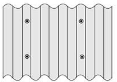
Paku setiap lembar asbes semen pada puncak gelombang ke dua dari kiri dan puncak gelombang ke dua dari kanan cukup menggunakan 2 s/d 4 paku (tergantung ukuran asbes semen). Beri jarak + 2 mm dari bidang asbes semen. Hindari pemakuan di tengah-tengah bidang asbes semen. Sebaiknya gunakan alat bor untuk melubangi lembaran asbes semen.
